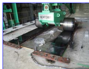
輪荷重走向疲労試験
